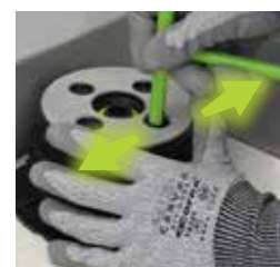
3. Coupez les ailettes avec la clé SUPAK.
