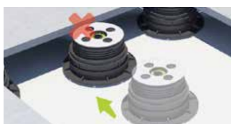
2. Acercar el soporte a la altura de las baldosas contiguas para poder modificar correctamente su altura.
