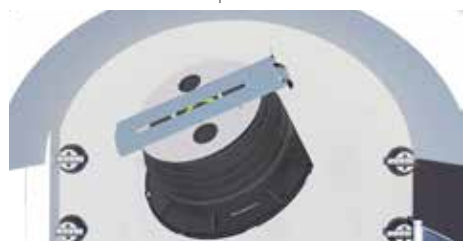
7. Colocar el clip SUPACLPP perpendicular a la pared.
