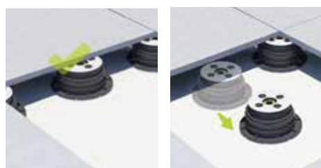
4. Una vez alcanzada la altura correcta, colocar de nuevo el soporte en el centro.
