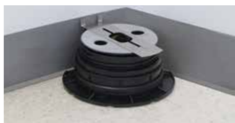
4. Positionnez un clip SUPACLPP en contact avec la paroi.
