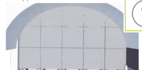
15. Couper les carrelages le long du mur à la forme correcte et les poser en suivant le schéma de pose.
