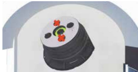
2. Retirer les deux ailettes parallèles à la coupe de l'embase.
